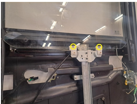
Irrota ovilasin kiinnityspultit. (hylsy 7 mm).
