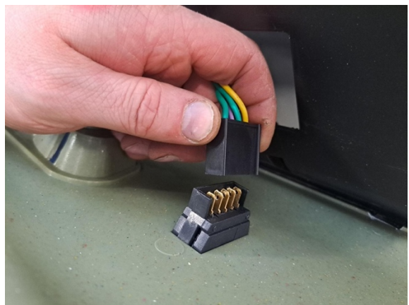
Irrota lasin nostinkytkimen liitin.
