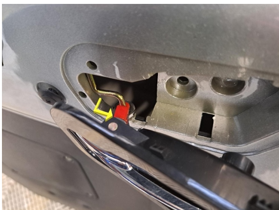
Raota oven sisäpuolen avauskahvaa ja avaa vivuston lukitusklipsu.
