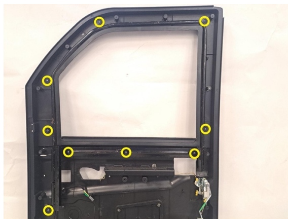
Irrota oven kannakkeen kiinnitysruuvit. (ristipäämeisseli ph2).
