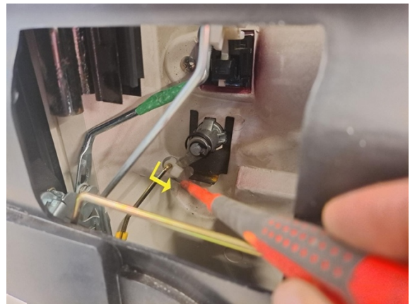
Avaa oven lukon vivuston lukitusklipsu. (pienitalttameisseli). Ota vivusto pois paikaltaan.
