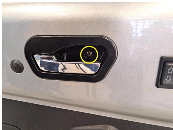
Irrota oven sisäpuolen avauskahvan kiinnitysruuvit. (ristipäämeisseli ph2).
